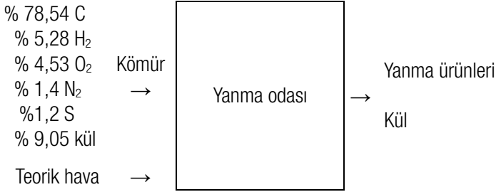
Şekil 16. Yanma odasına giren çıkan bileşenler
